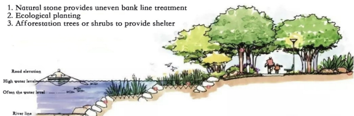
Рис. 1.9 Разрез конструкции эколого-инженерной облицовки.
