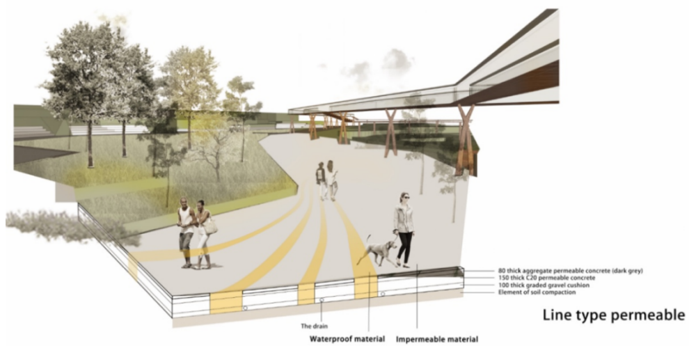
Рис. 1.46 Схема проницаемого покрытия 4.
