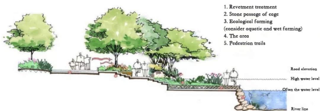
Рис. 1.13 Разрез конструкции травянистой облицовки склона.
