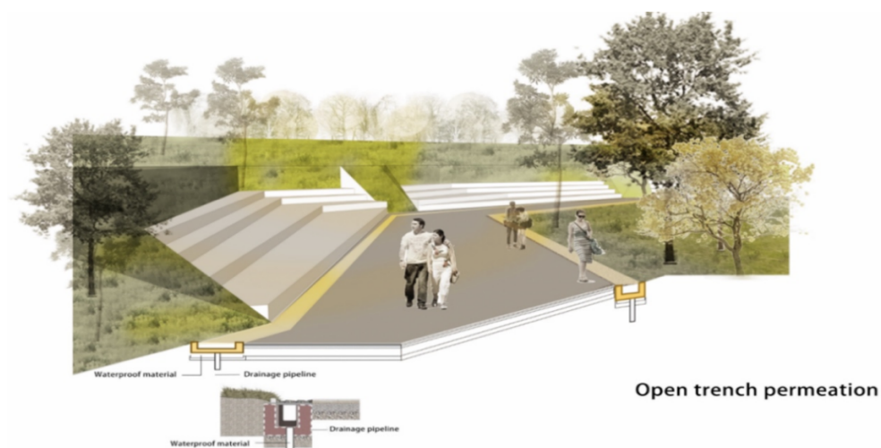
Рис. 1.43 Схема проницаемого покрытия 1.
