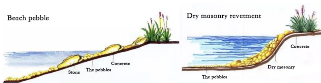
Рис. 1.11 Структура естественной облицовки блочного типа.
